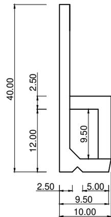
Formulation béton : Ciment 52.5, sable, adjuvants, fibre de verre.
